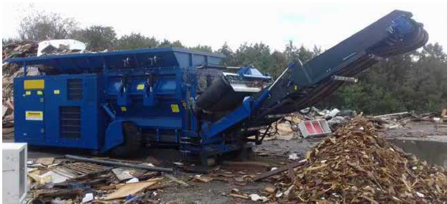
Drveni otpad usitnjava se specijalnim strojevima
