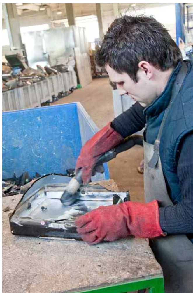
Odstranjivanje fosfora s unutarnje stjenke tv ekrana
