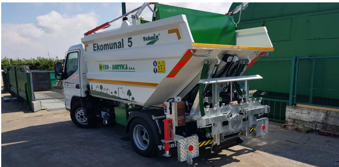
Specijalno vozilo s dvije odvojene komore u teretnom prostoru za istovremeno sakupljanje papira, plastike ili drugih frakcija. Na ovaj način smanjuju se troškovi prijevoza otpada.
